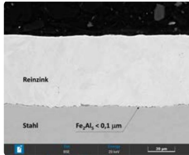
**Zink** - Die Auflage besteht aus ca. 99,8 % Zink + 0,2 % Aluminium. An der Phasengrenze zwischen Stahl und Zink bildet sich eine intermetallische Verbindung. Diese sehr dünne Schicht wirkt haftvermittelnd, unterdrückt aber auch die Bildung der unerwünschten FeZn-Legierung.
