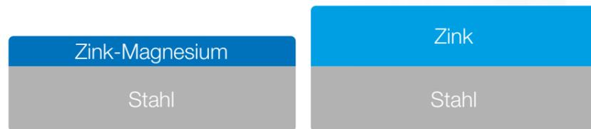
Empfohlene Beschichtungsdicke: 1:2 für ZM im Vergleich zu Z
